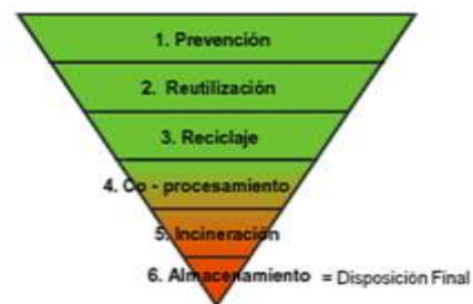
Figura 10. Pirámide jerárquica del manejo de los residuos y desechos sólidos. Fuente: Celli, 2004.
