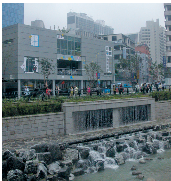
Soutien du débit à l'étiage de la rivière Choeng Gye Choen à Séoul par l'eau d'exhaure du réseau de métro
