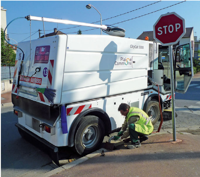
Engin de nettoyage alimenté par une bouche de remplissage, La Courneuve
