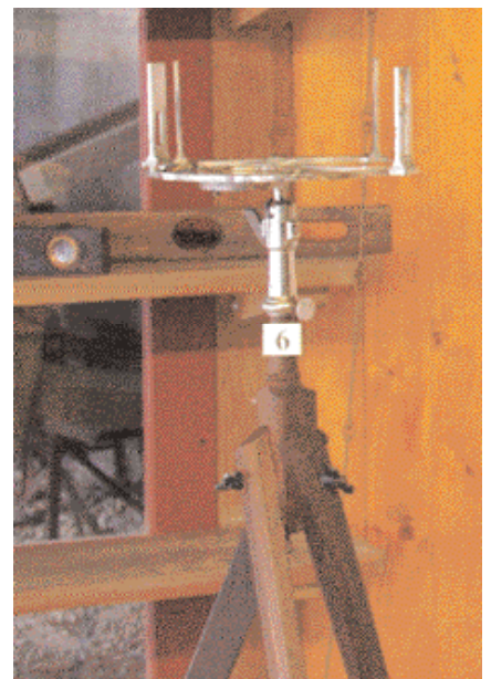
Photo d'un dessin de “levé à la planchette” , trouvé sur une paroi des galeries de servitude de l'IDC dans le 13 e arrondissement. Cet appareil était utilisé pour mesurer les angles, le plan étant dessiné lors du levé, à la main, sur une feuille de papier posée sur la planchette.
