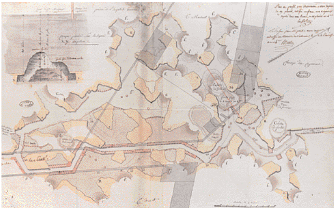
Plan des carrières et des consolidations sous la rue de la Santé, entre le champ des Capucins et le jardin de "l'hôpital vénérien" (actuel hôpital Cochin). Ce levé a été exécuté en l'an 4, sous l'Inspektorat de Bralle.
