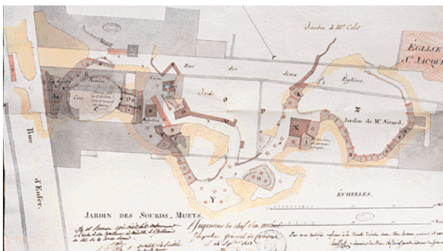
Plan des carrières et des consolidations sous la rue de la Santé, entre le champ des Capucins et le jardin de "l'hôpital vénérien" (actuel hôpital Cochin). Ce levé a été exécuté en l'an 4, sous l'Inspektorat de Bralle.
